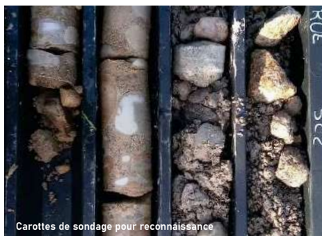
Carottes de sondage pour reconnaissance
